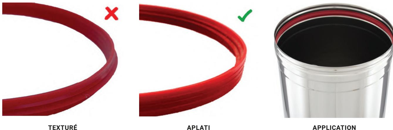
L'application se fait avec la partie aplatie fixée á l'acier inox autour du raccord femelle laissant la partie texturée face á l'intérieur du tube de sorte que lors du montage d'un autre tube, cette partie texturée ne laisse aucun espace entre les deux.
